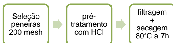
Figura 1. Esquema do pré-tratamento da CCA.
