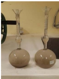
Figura 3 – Determinação da massa específica real, (Frasco Chapman). Fonte: autor (2015)
