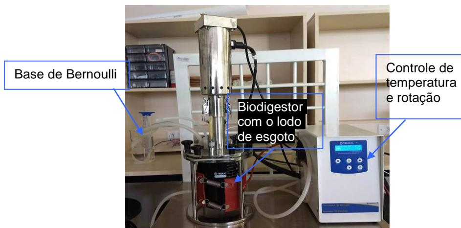
Figura 3 – Biodigestor acoplado à base de Bernoulli
