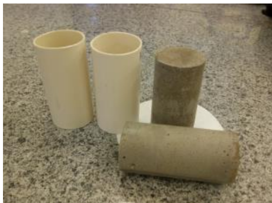
Figura 4 - Corpos de prova desmoldados
